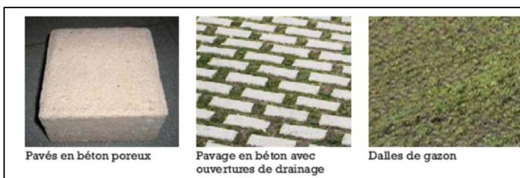
Figure 26 : Exemples de structures poreuses
